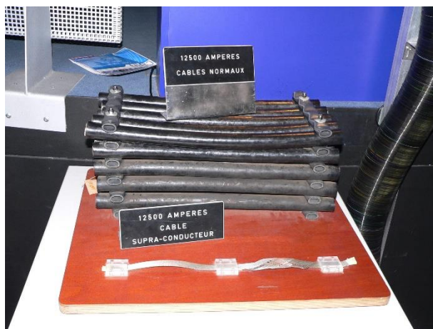
Рисунок 4.7. Слева – сравнение обычного (чёрный) и сверхпроводящего (белый) кабеля, рассчитанных на одинаковую нагрузку в 12 500 ампер (экспозиция ЦЕРН). Справа – структура метастабильного при атмосферном давлении полигидрида урана с теоретически предсказанной сверхпроводимостью при 193 К (Kruglov et al. 2017)..
