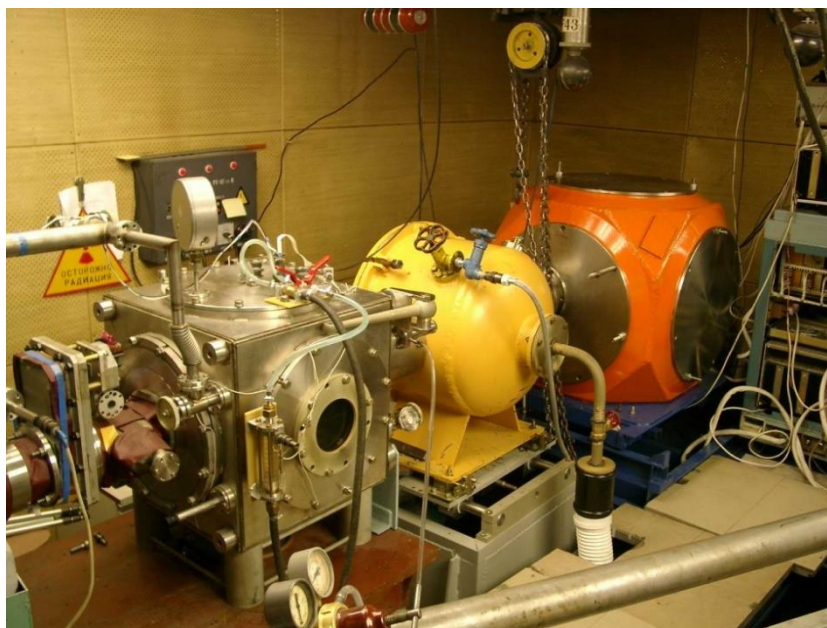
Рисунок 4.10. Фотография экспериментального стенда для исследования детонационных и ударноволновых процессов в бункере ВЭПП-3 (ИЯФ СО РАН).
