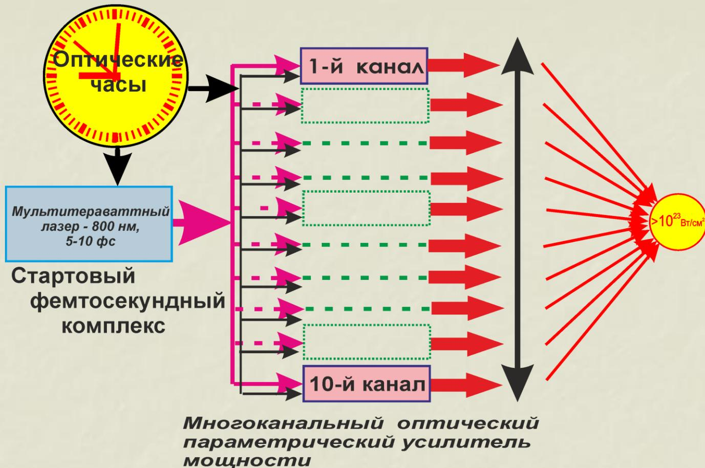
**лазерный комплекс** экстремально высокой ультрарелятивистской интенсивности (более  $10^{23}$  Вт/см<sup>2</sup>), уникальная активная синхронизация каналов усиления оптическими часами, когерентное сложение полей излучений, предельно высокий контраст импульсов
