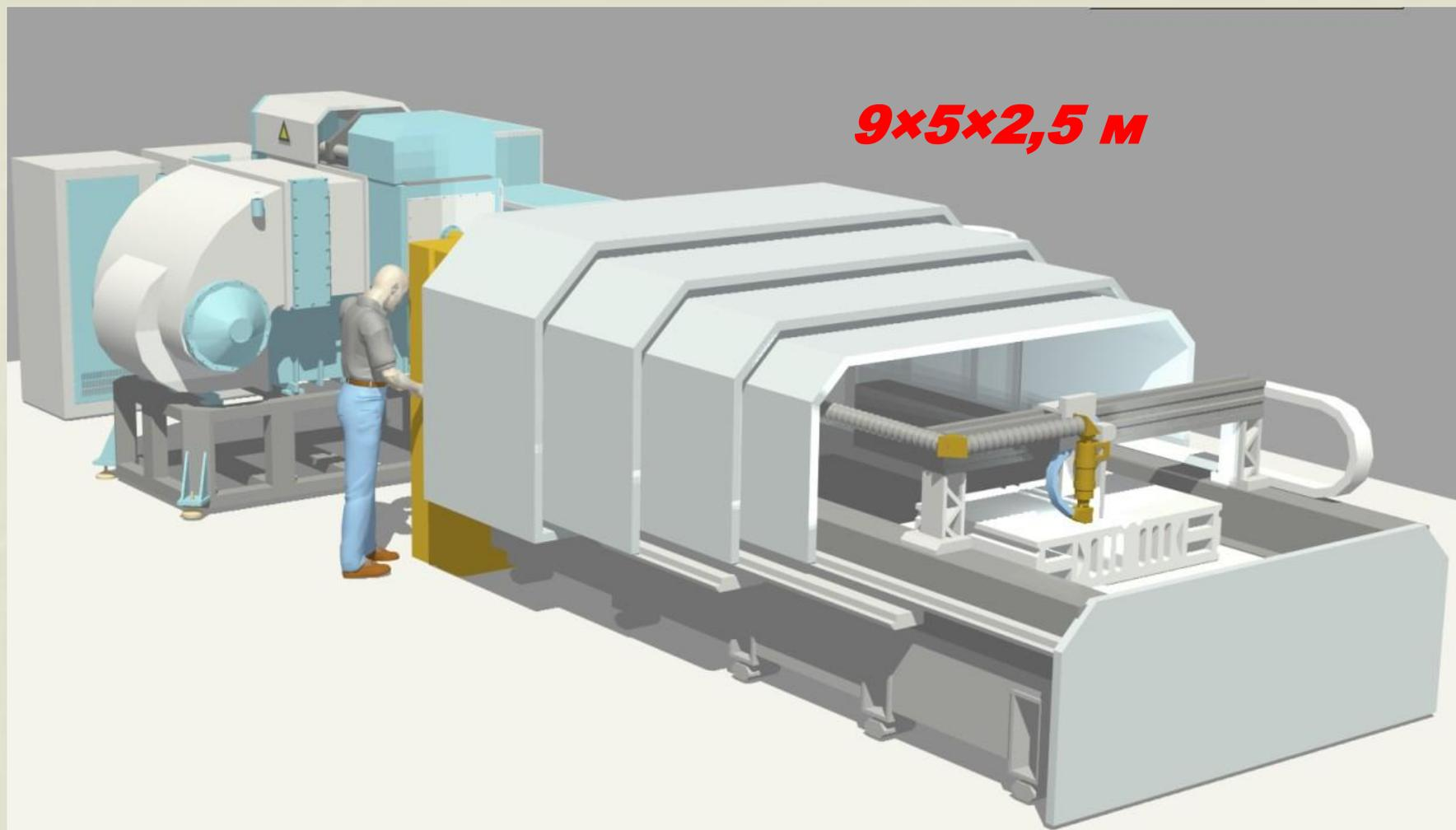
**5 кВт многофункциональная лазерно-плазменная технологическая установка для 3D аддитивных технологий с полем обработки - 1200×2500×300 мм**
